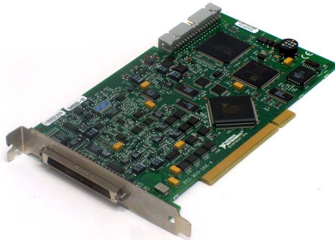
Abb. 2.4.1: Multifunktions-Datenerfassungsmodul NI PCI-MIO-16E-4 (National Instruments Germany GmbH, 2013)
